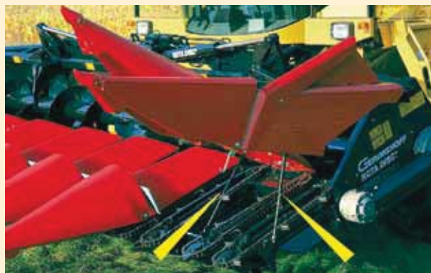
提高保护：工业气弹簧保护重盖子。
