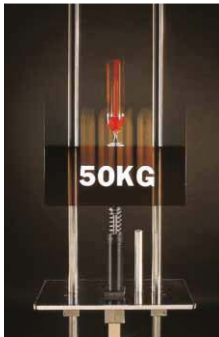
一个盛满红酒的酒杯从1.3m 的高度自由落体，冲击到 ACE 吸震器上，没有溢出一滴酒。（这是 ACE 吸震器完美品质的见证！）
